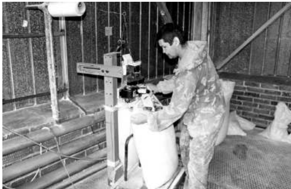
За 12 часов работы мельница перерабатывает порядка 3,5 тонны зерна, производя в среднем от 40 до 60 тонн муки в месяц.
